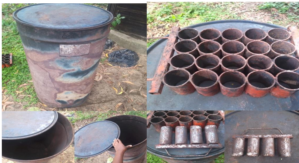
Figure 3. Carbonisateur et moules à briquettes
