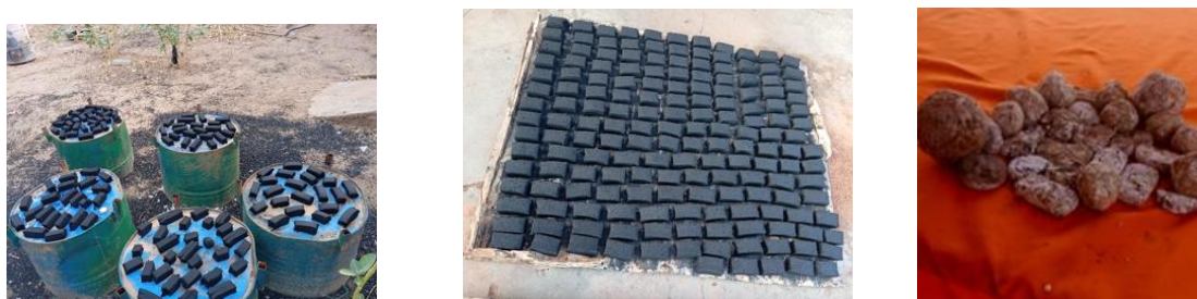
Figures 5, 6 et 7. Séchage du charbon à base de déchets organiques et de papiers, © Sidonie A. Ima/Ouoba
