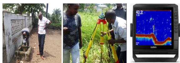
Figure 6. (a : gauche) Une vue du levé topographique au GPS GARMIN 62 TS ; (b : centre) Une vue du levé de précision au GPS Différentiel ; (c : droite) Sondeur GARMIN STRIKE CHIRP4
